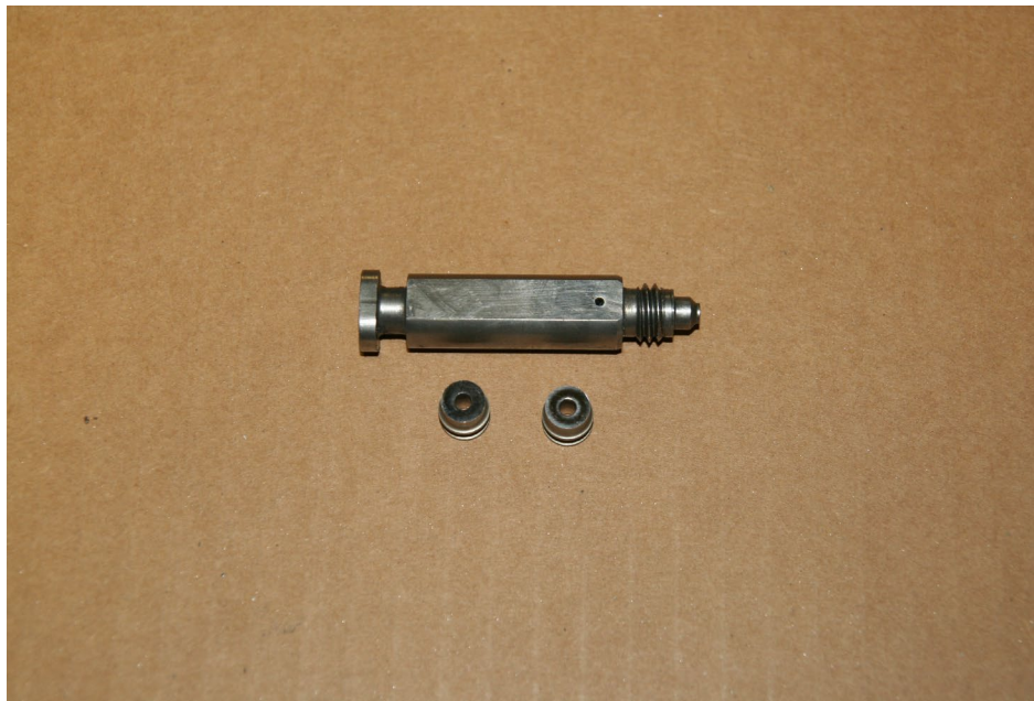
Cámara de mezcla AR5252 y sellos laterales de acero para la pistola de pulverización Graco Fusion AP.
