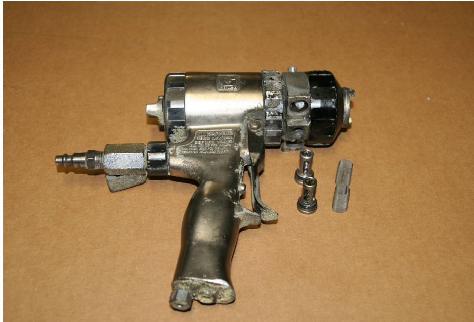
Pistola Graco Fusion AP. Retire y deje fuera los filtros de la pistola.
